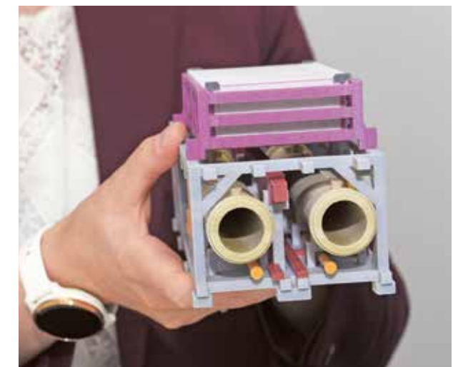
Einblick: Ein Elektrolyse-Gestell besteht aus rund 80 Elektrolysezellen und je einem Behälter für Wasserstoff und Sauerstoff. Eine „Scalum“-Einheit enthält vier solcher Gestelle.
